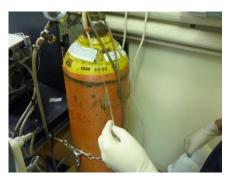
4.- Seal the tube using Parafilm®
